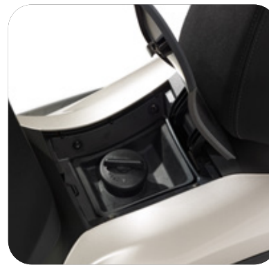
TAPÓN DE COMBUSTIBLE COLOCADO EN EL TÚNEL
